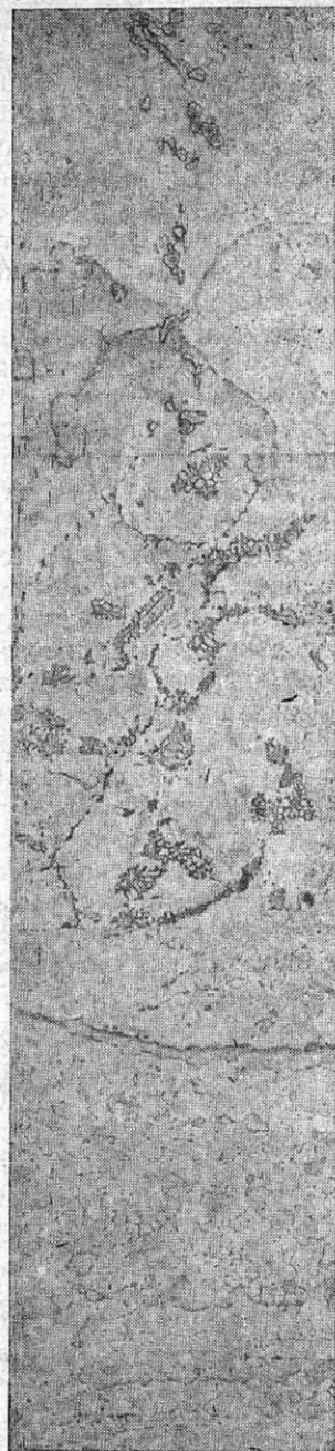
Рис. 79. Структура сварного соединения при КСС пресс-профилей сплава 1201 с предварительным подогревом перед осадкой ( \times 320 ).
